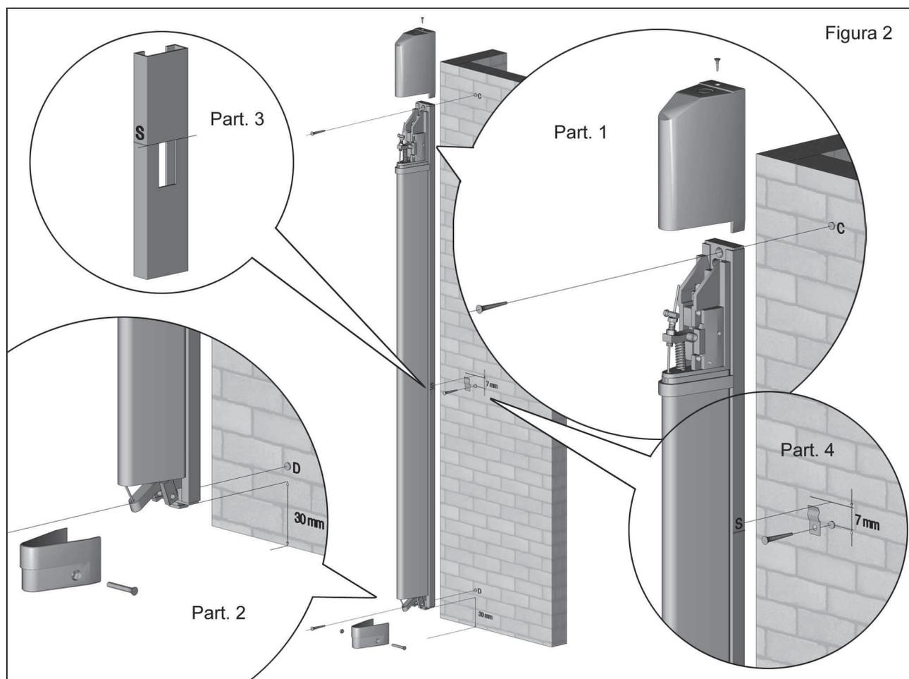
9. Riagganciare il dispositivo sulla molla e procedere con il fissaggio delle viti.
