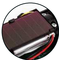
Funcionamiento combinado. Batería-panel solar.
